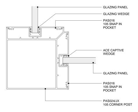
POTTER ALUMINIUM SYSTEMS A SERIES 105 - 64MM - GLAZING CORNER POSTS SINGLE GLASS PLAN VIEW
