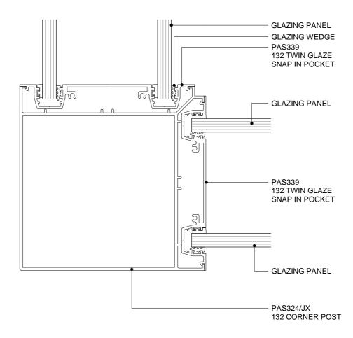
POTTER ALUMINIUM SYSTEMS A SERIES 132 - 92MM - GLAZING CORNER POST DOUBLE GLASS PLAN VIEW
